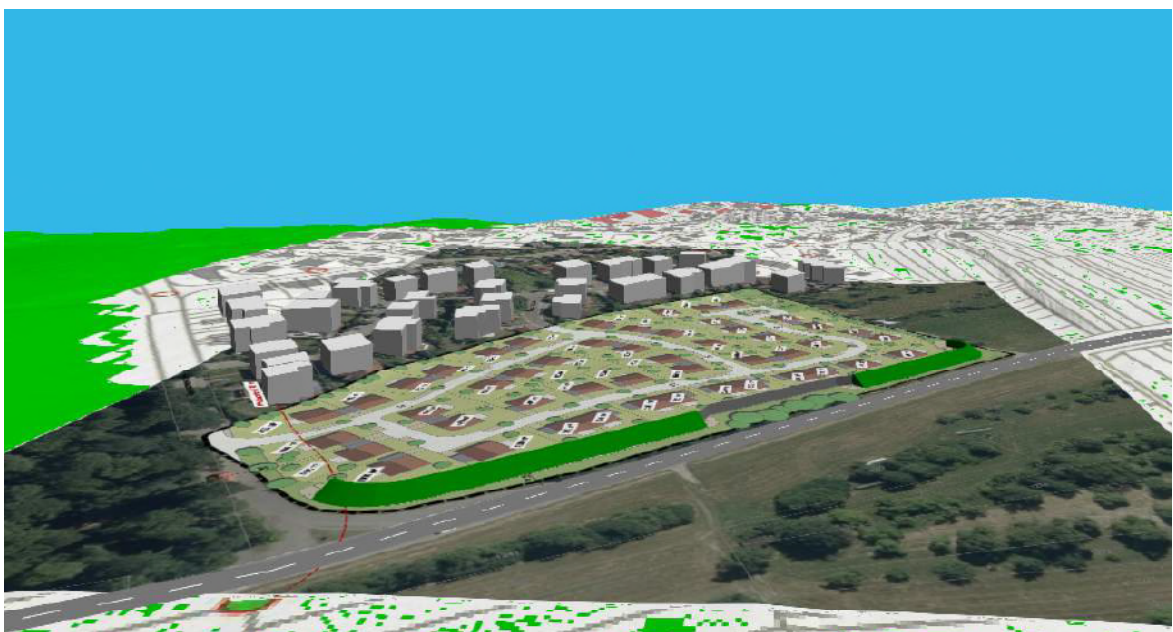
Bild 2: Ausschnitt aus dem digitalen Geländemodell mit 3m hohem aktiven Schallschutz
